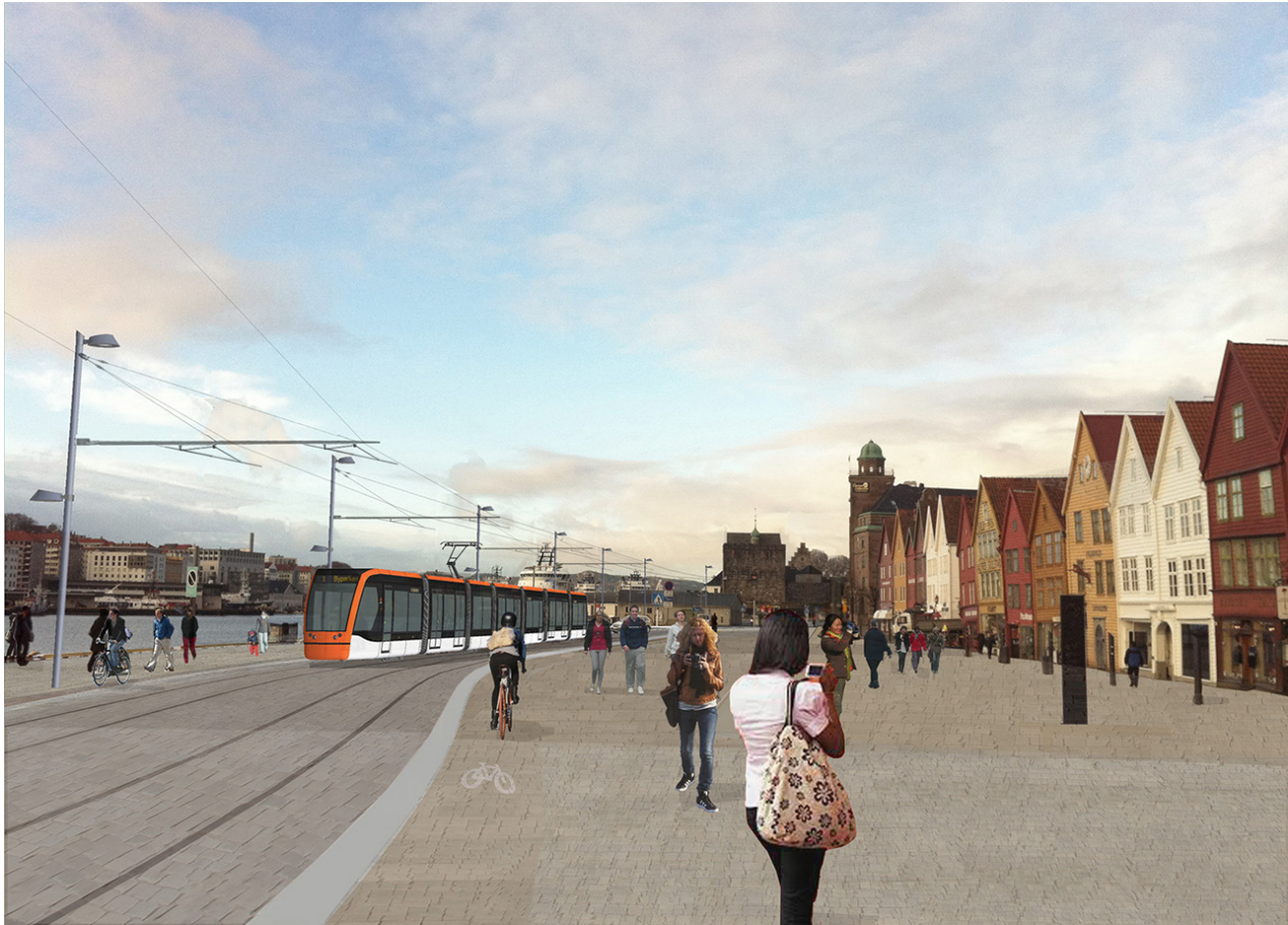
Situasjon med Bybane over Bryggen, med ensidige master og kjøreledningssystem.
